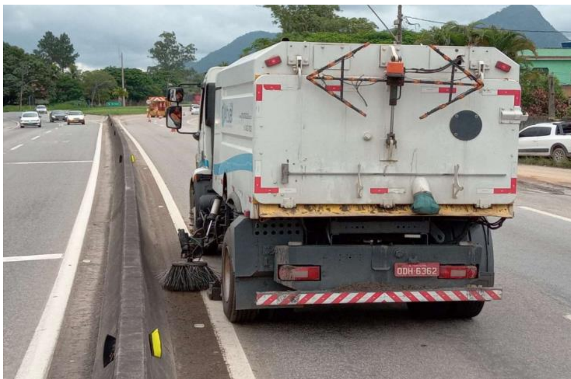
FOTO 11 – Varrição Mecânica de Mediana – Km 13+000 Sul
